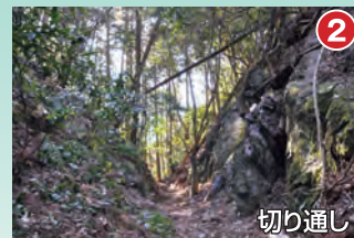
切り通し 女鬼峠は石墨千枚岩を掘割って通した峠道です。当時の掘削技術を考えると、かなりの難工事であったのではないかと思います。
